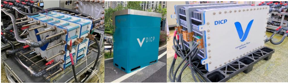
图1 分布式储能用 10kW 级可焊接电堆、10kW/ 30kWh 用户侧储能系统和规模储能用 30kW 级可焊接电堆
